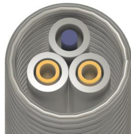
Abbildung 1: Möglicher Aufbau eines Miniatur-Endoskops bestehend aus drei Eccentric Tubes mit Spül- und Arbeitskanälen (gelb) sowie Bildgebungsleitung (blau) | Julia Narr
