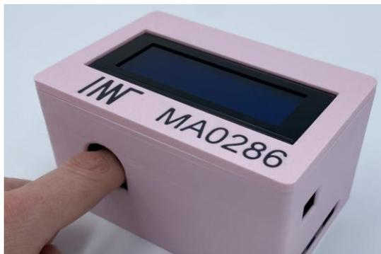
Abbildung 1: Prototyp zur Blutdruckmessung mittels Photoplethysmographie
