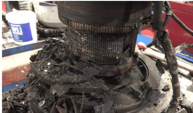
Beispielhafter Zustand eines offenbar überlasteten Motors [Fletcher Moorland]
