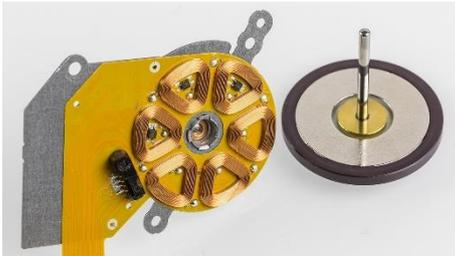
Abbildung 1 Scheibenläufer BLDC mit axialem Feld und auf einem PCB gewickelten Spulen [Wikipedia]
