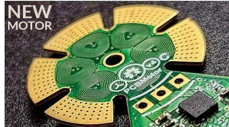
Abbildung 2 Beispiel Platinen-basierter Axialfluss-Motors [Carl Bugeja]
