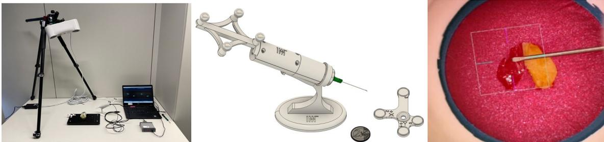
Sensorsystem am IMT (links und mittig) und typischer Arbeitsschritt in der Augenchirurgie (*Kapsulorhexis*) bei der typischerweise sehr geringe Interaktionskräfte auftreten
