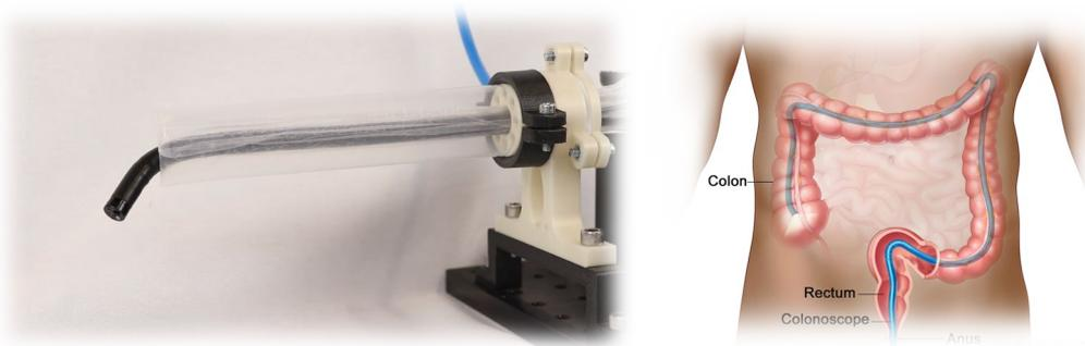
Prototyp eines expandierenden Koloskops (links, eigene Abbildung) und schematische Darstellung einer Koloskopie (rechts, herold.at)
