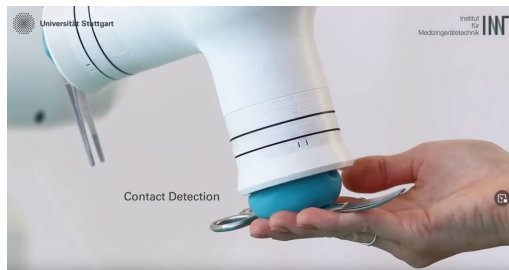
Robotic Scrub Nurse des IMT (links) und Handover-Prozess von Hand zu Greifer (rechts)
