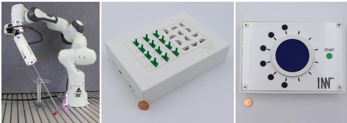
*Medizinrobotersystem des IMT (links), Pick- and Place-Test (mitte) und Test zum Finden einer in Silikon gegossenen Struktur durch Palpation/Tasten (rechts)*
