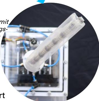
Vorarbeiten haben gezeigt, dass für das Vorankommen im Darm eine in den Roboterkörper integrierte Richtungssteuerung unabdingbar ist. Aktuell werden unterschiedliche Konzepte zur Realisierung der Richtungssteuerung untersucht. Dazu zählen die Richtungssteuerung über Pneumatic Artificial Muscles (PAMs), ein System im Roboterlumen und einem externen Richtungssteuerungstool.
