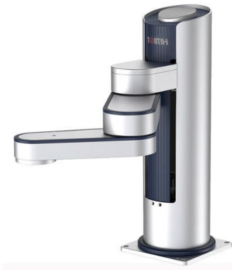
SCARA-Arm der Firma HitBot [ https://www.hitbot.eu/DE/arm.htm ]
