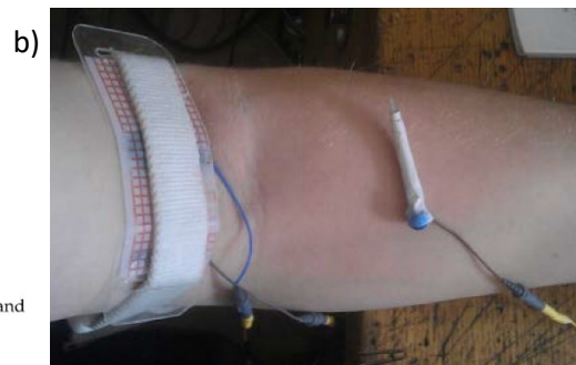
Abb. 1: a) Schematischer Aufbau des Messsystems. b) Experimenteller Aufbau bestehend aus dem entwickelten Elektrodensystem und der eingestochenen Nadel. [Kudashov, Ivan et al. "Smart Bio-Impedance-Based Sensor for Guiding Standard Needle Insertion." Sensors (Basel, Switzerland) vol. 22,2 665. 15 Jan. 2022]
