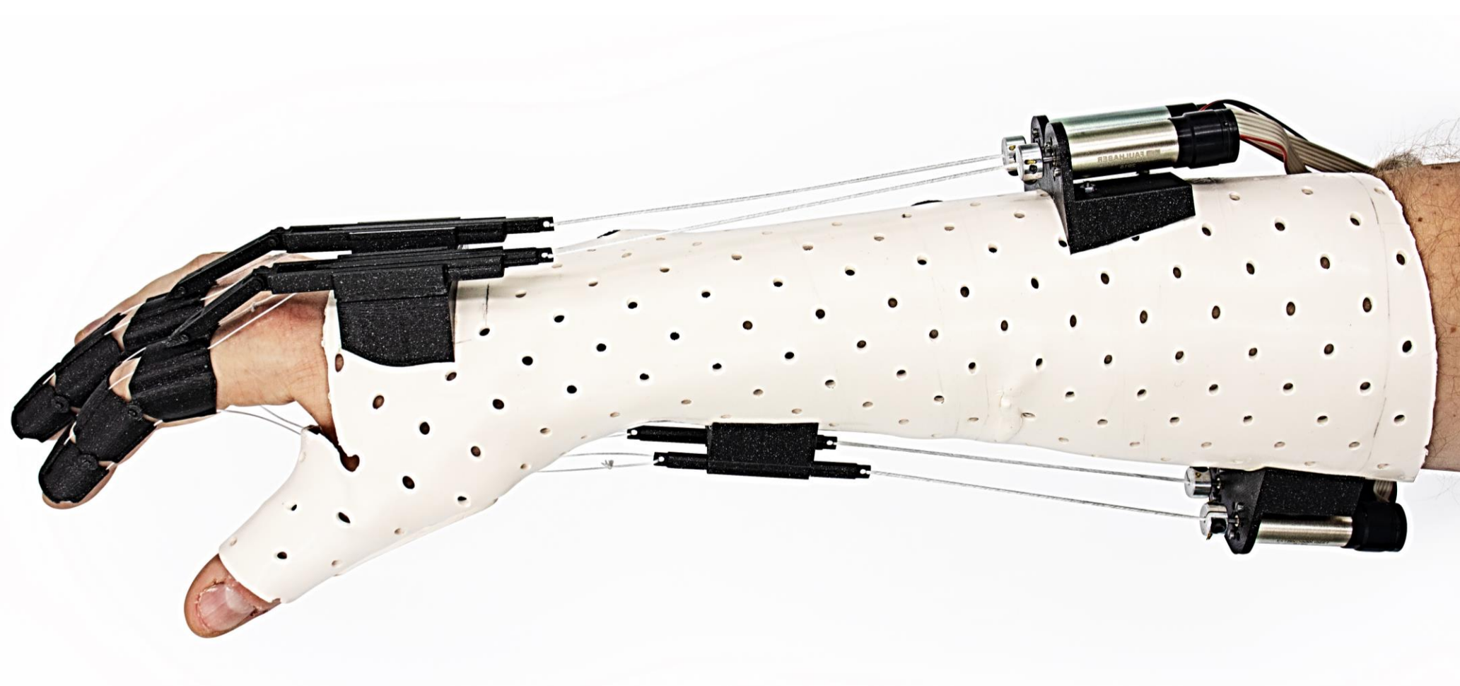
Figure 2: Demonstrator der entwickelten Handorthese mit TSA am Arm eines Probanden
